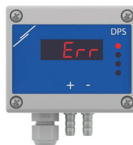
Фиг. 15 Повреда на сензорния елемент
