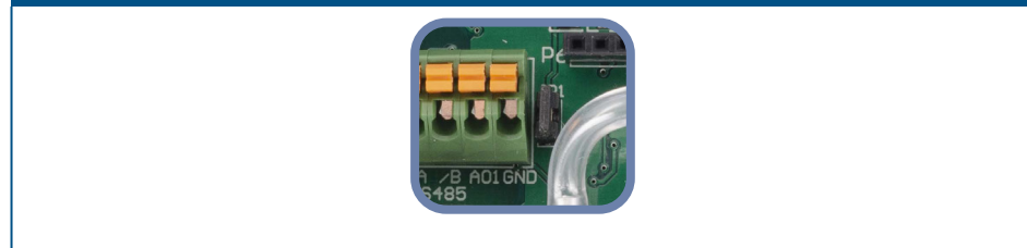
Фиг. 5 Свързан джъмпер за съгласуващия резистор
