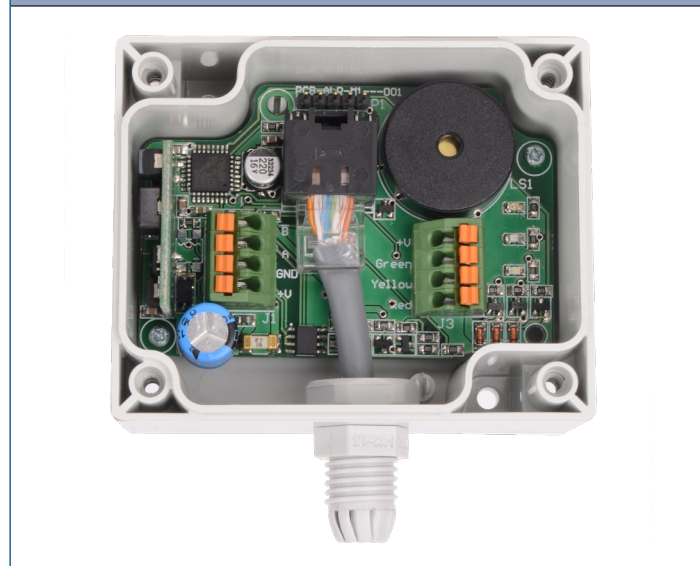
Фиг. 3а Свързване чрез RJ45
