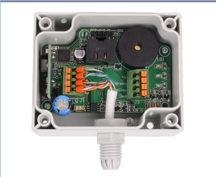
Фиг. 3б Свързване чрез клеморед
