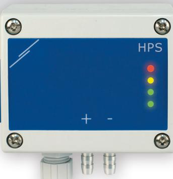
HPS-M--LP представляват високочувствителни трансмитери за диференциално налягане (-125–125 Pa) с комуникация по Modbus RTU, оборудвани с изцяло цифров преобразувател на налягане и проектирани за използване в широк кръг от приложения. Отчитането на скоростта на въздушния поток е възможно посредством свързване на тръба на Пито. Те се захранват и всички параметри са достъпни чрез Modbus RTU протокол - приложението 3SModbus или Sensistant.
