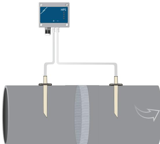
**Приложение 2:** Измерване на подадения въздушен обем [ $m^3 / h$ ] или скоростта на въздушния поток [ $m / s$ ] с помощта на PSET-PT
